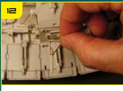
Вклейте основание A-образной рамы в два отверстия возле турели, а верхнюю часть приклейте к самой турели.
